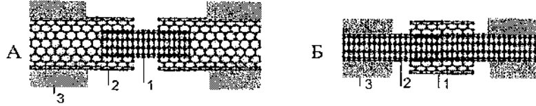
Рис. 1. Схемы электромеханических нанотермометров на основе ДУНТ: телескопический нанотермометр с подвижным внутренним слоем (А); нанотермометр с подвижным челноком из внешнего слоя (Б). 1 – подвижный слой, 2 – фиксированный, 3 – электроды
