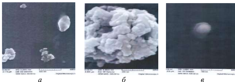
Рис. 7. Структура частиц бемита: а – увеличение 80 000; б – увеличение 200 000; в – увеличение 400 000
