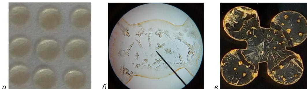
Рис. 2. Исследование морфологий осадений массивов капель коллоидных растворов: *а* – внешний вид первого массива капель 3\*3; *б* – «мостик» второго массива между двумя каплями первого; *в* – «мостик» второго массива между четырьмя каплями первого
