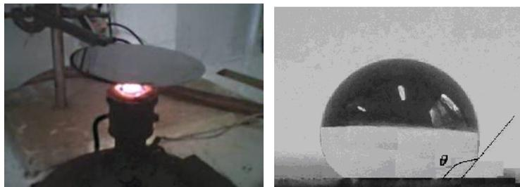
Рис. 2. Фотография экспериментальной установки и капля жидкости на супергидрофобной поверхности [9]
