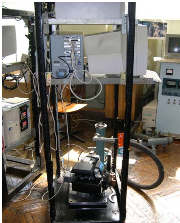
Рис. 2. Общий вид экспериментального стенда с управляемым высоковольтным источником и системой регистрации температур (вверху), персональным компьютером (в центре) и модульной системой нейтрализации (внизу) при использовании барьерного разряда при напряжении до 40 кВ (частота разрядных импульсов 28 кГц).
