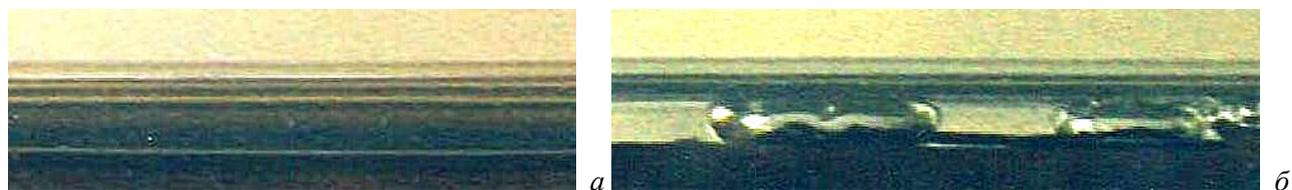
Рис. 7. Режимы течения в кольцевом канале испарителя: а – расслоенный; б – снарядный
