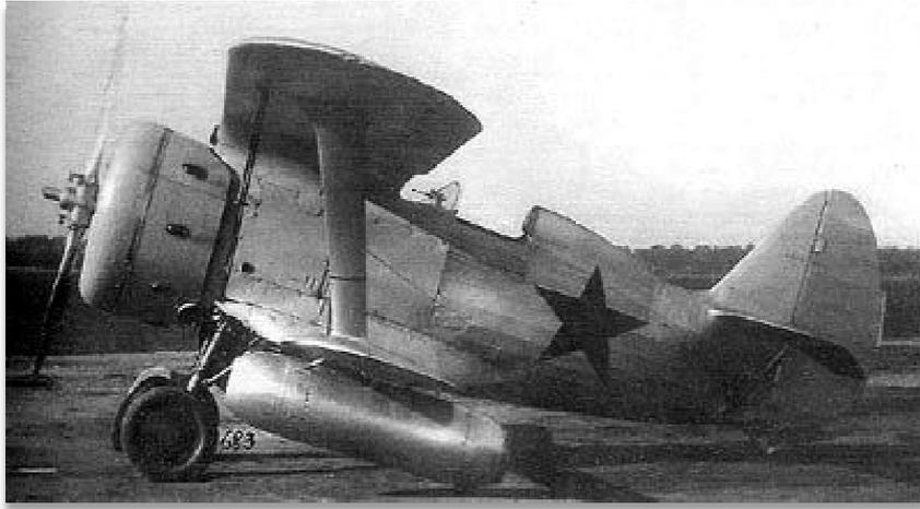
Рис. 9. Самолет И-153 с двумя установленными ПВРД ДМ-2
