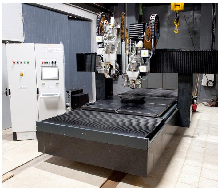
Участок по разработке и изготовлению оборудования для полирования прецизионных деталей с использованием магнитореологических жидкостей
