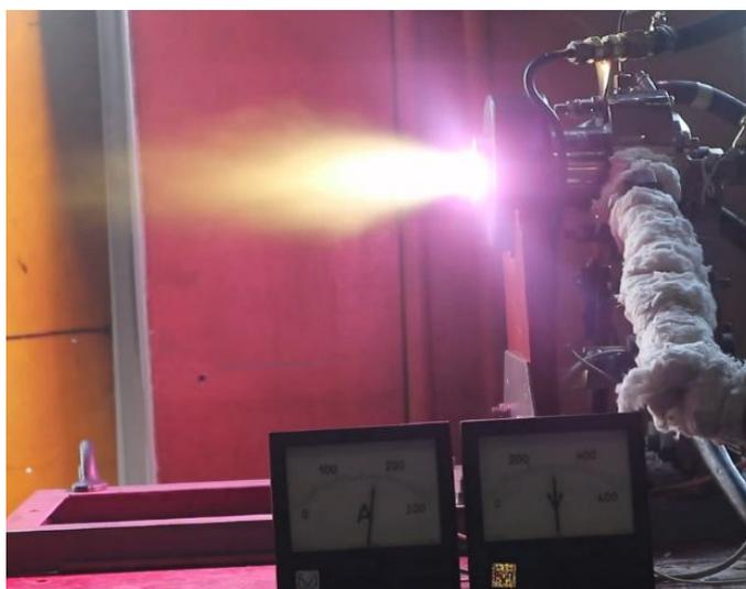
Плазмотрон ПП-60, работающий на водяном паре
