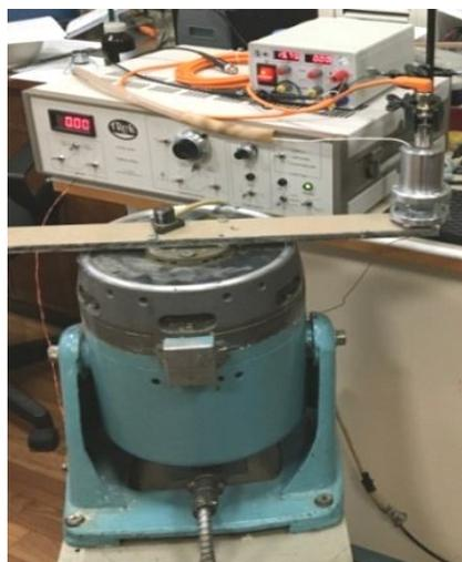
Рис. 2. Вибростенд для исследования колебаний макета различных объектов
