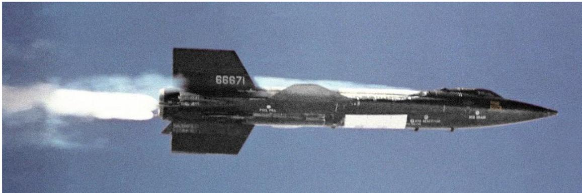
Рис. 11. Экспериментальный ракетоплан X-15
