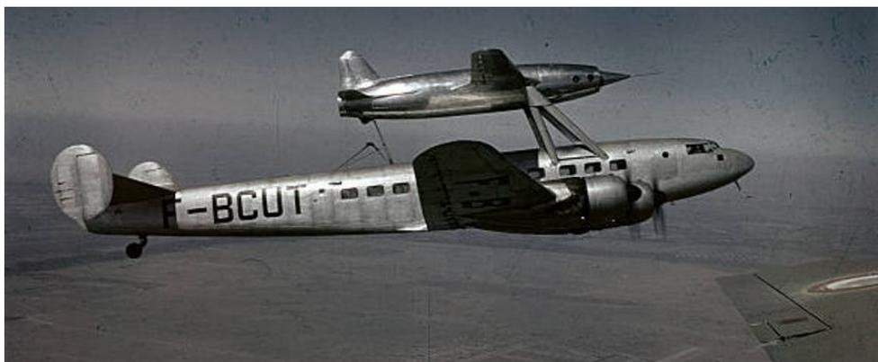
Рис. 7. Самолет Leduc 0.10 на самолете-носителе SNCASE SE.161 Languedoc
