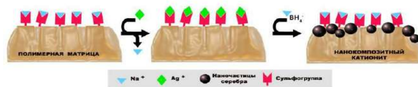
Рис. 1.Схема синтеза наночастиц серебра на поверхности полимерной ионообменной матрицы
