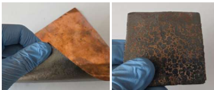
Рис. 1. Пример двухслойной фольги (медь-РГ) (слева) и объёмного композита РГ с медной пеной (справа)
