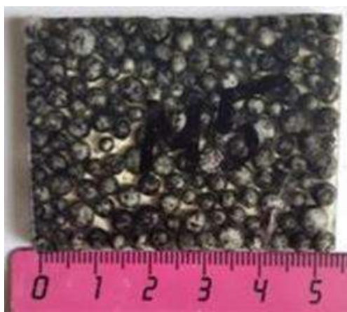
Рис. 2. Экспериментальный образец электромагнитного экрана на основе полистирольных шариков, покрытых MXene
