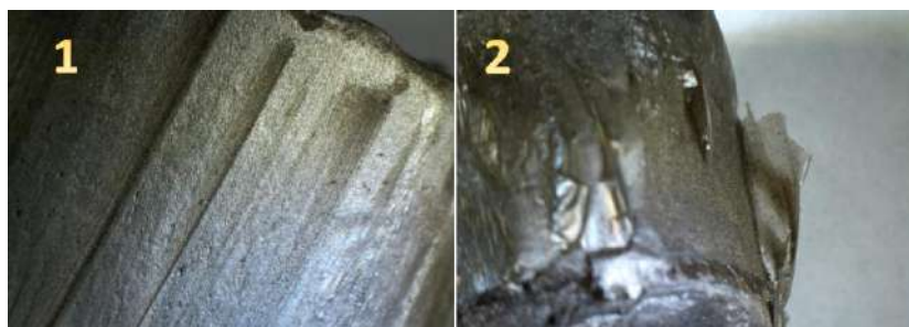
Рис. 2. Оптическая фотография поверхности монолита АОГ до облучения (1) и после облучения дозой 220 кГр (2)
