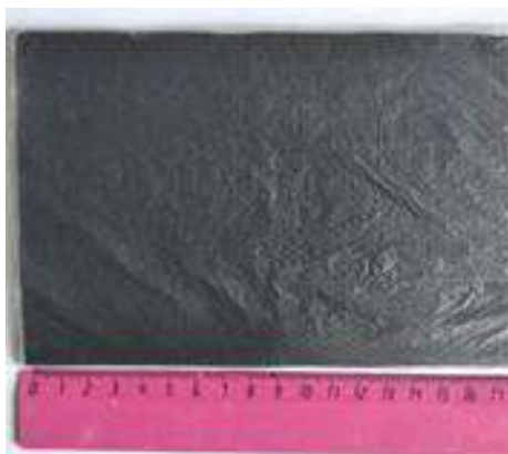
Рис. 1. Экспериментальный образец войлока угле-волокнистого «Карбопон-В-22», пропитанного коллоидным раствором MXene ( Ti_3C_2 )
