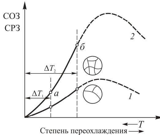
Рис. 5.11. Изменение скорости образования зародышей СОЗ (1) и скорости роста кристаллов СРЗ (2) в зависимости от степени переохлаждения \Delta T . На вставках схематически показаны крупнозернистая (нижняя) и мелкозернистая (верхняя) структуры поликристалла, формирующиеся при переохлаждениях \Delta T_1 и \Delta T_2 соответственно
