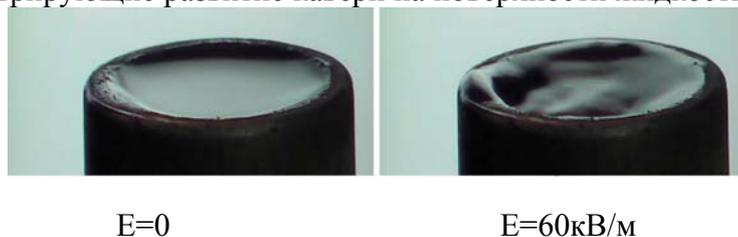
Рис.3. Поверхность горящей жидкости
