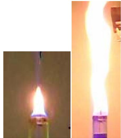
Рис. 1. Изменение размера факела при воздействии электрического поля на границу раздела фаз
